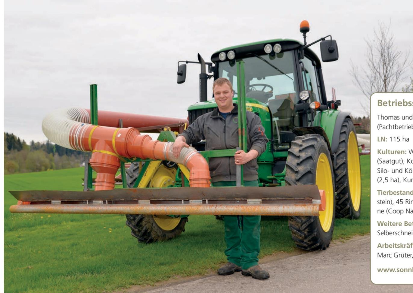
Zwölf Meter Arbeitsbreite, hydraulische Höhenverstellung, Hangausgleich. Anderthalb Stunden hat Marc Grüter gebraucht, um die 1,5 ha Raps abzufahren.
