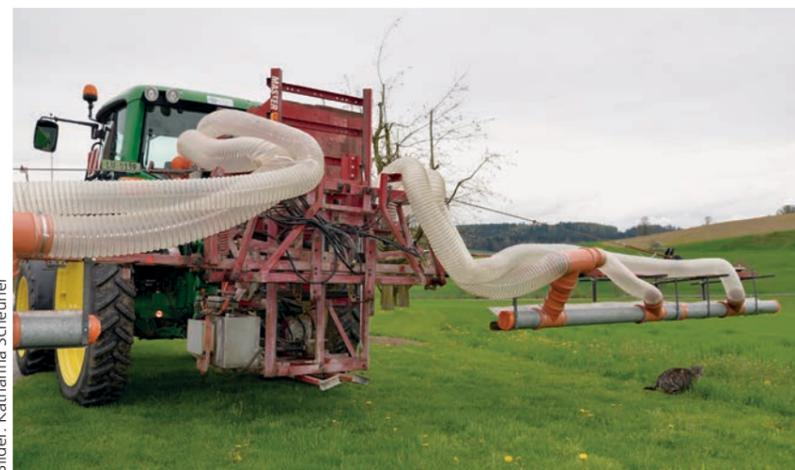
Aus einer alten Feldspritze, einem Heugebläse, einem Hydromotor, vielen Metern Schläuchen und Rohren haben Grüters einen Rapsglanzkäfer-«Sauger» gebaut.
